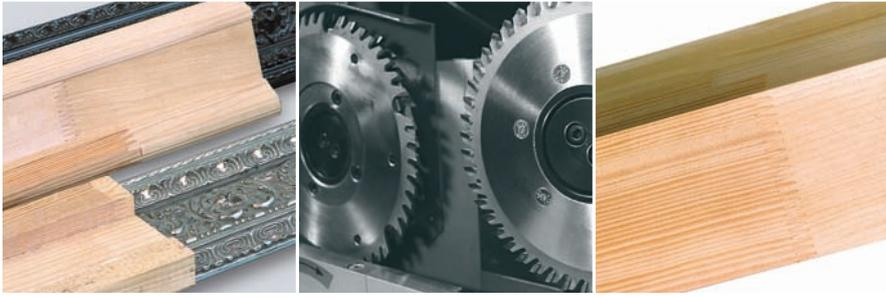
Durch die vorschubstarken, frequenzgeregelten Frästischmotore garantiert diese Anlage ein gleichmäßiges, präzises Schnittbild über die gesamte Paketbreite.
