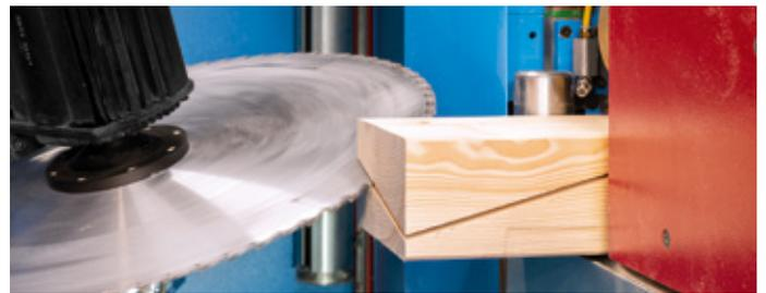
Im Gegensatz zu einer Lösung mit Untertischkappsäge kann das Sägeblatt unter die Nullposition schneiden und Schlitz in beliebigen Winkeln und in allen benötigten Stärken fertigen.
