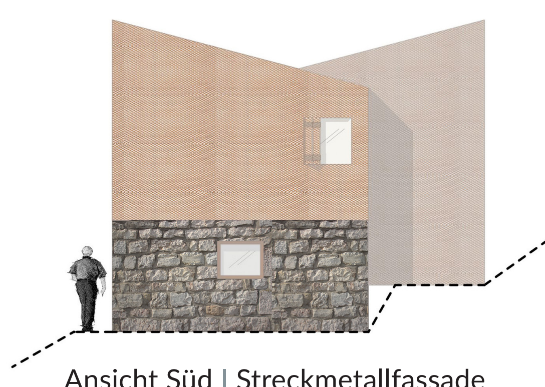
Ansicht Süd | Streckmetallfassade
