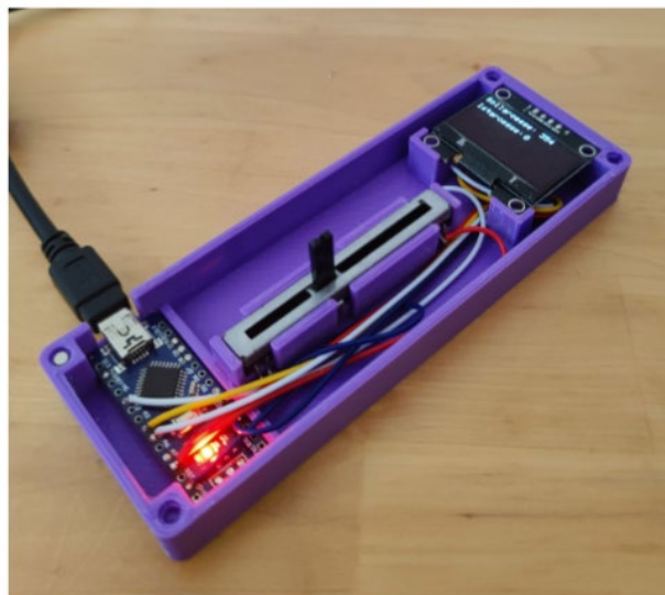
Abbildung 2: Erster Prototyp der Fernbedienung [1, Seite 54]
