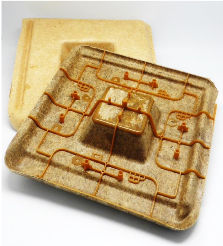
Thermoplastischer Hybridverbund (FRIMO) mit Natur- und Holzfasern (links); Teil des Hybridverbundes für instrumentierten Durchstoßversuch (rechts)
