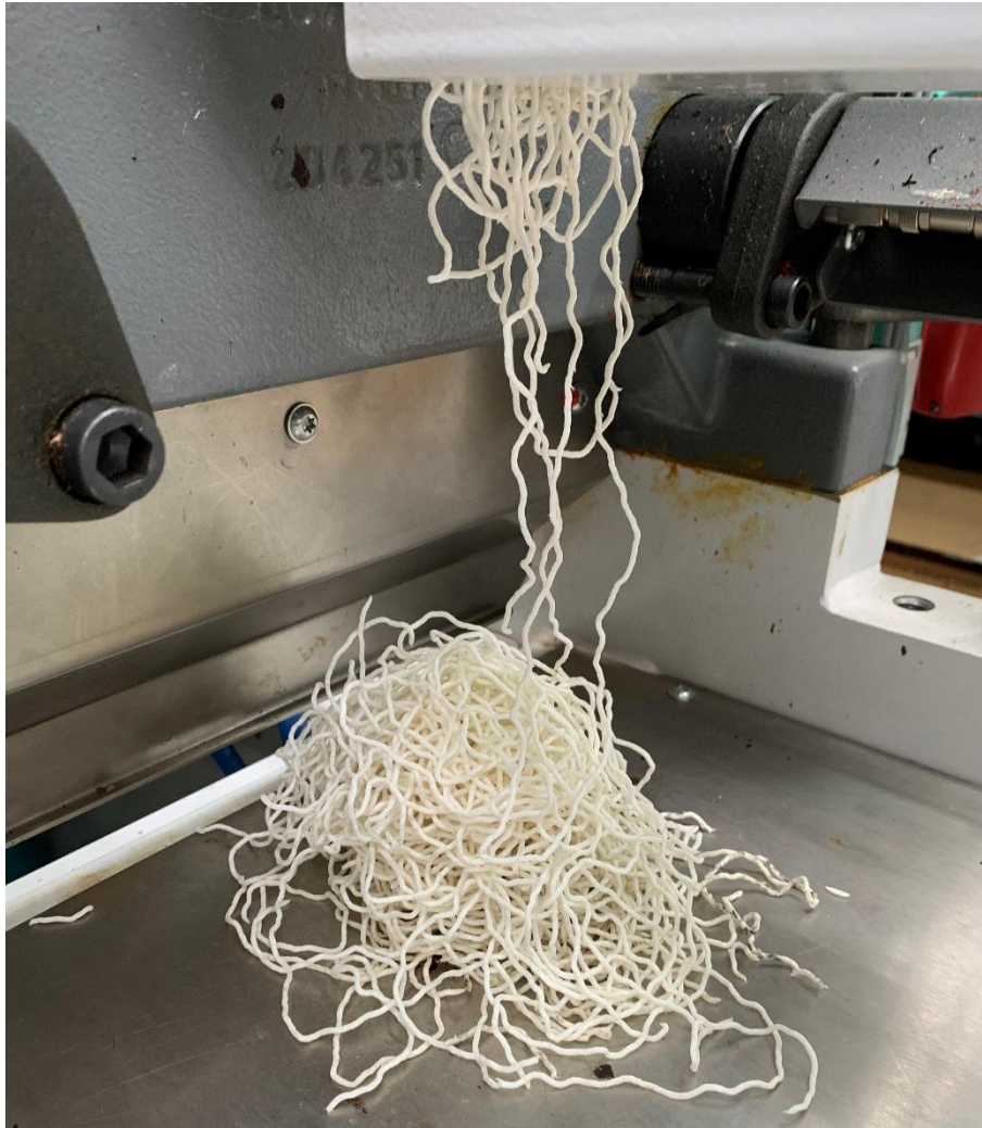
Ausgespritzter Papiergrundstoff (endloser Strang)
