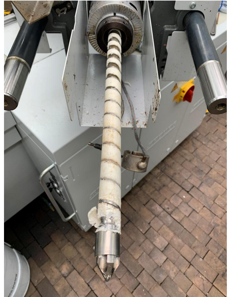
Gezogene Spritzgusschnecke nach Aufdosierung
