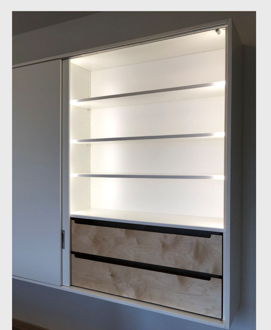
Abb. 3 - 5: Beispiele für „Licht zum Sehen“: links: Nachtlit unter dem Bett; Mitte: Spiegel mit beidseitiger Beleuchtung; rechts: Schrankbeleuchtung mit vertikalen Profilleuchten.
